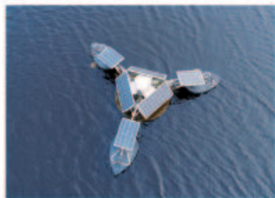
▲ 图4-11 应用太阳能水生态修复系统改善湖水水质
